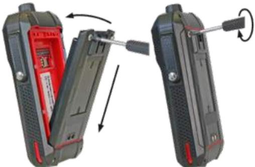
» 그림에 나온 것처럼 배터리를 배터리 홀더에 넣으십시오. 배터리와 장치의 금색 접촉부가 서로 마주보도록 만듭니다.
