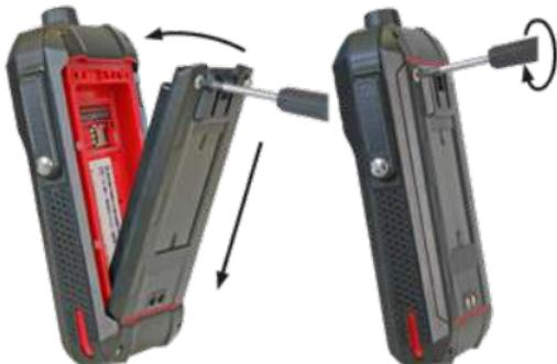
» 그림에 나온 것처럼 배터리를 배터리 홀더에 넣으십시오. 배터리와 장치의 금색 접촉부가 서로 마주보도록 만듭니다.
